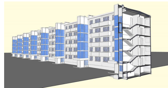
Рисунок 3 – Предполагаемое устройство лифта [2]
